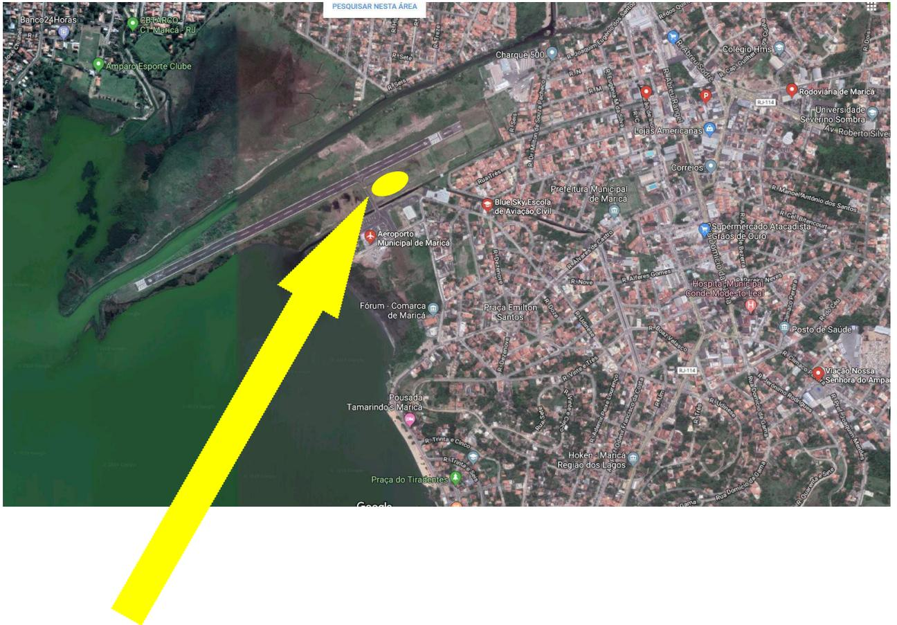
ÁREA DESTINADA A CONSTRUÇÃO DE ACRÉSCIMO DO PÁTIO DE AERONAVES LAJE EM CONCRETO PROTENDIDO  $h = 20$  cm.
